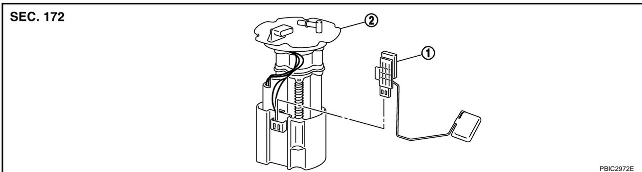
1. Boîtier de capteurs de niveau de carburant
