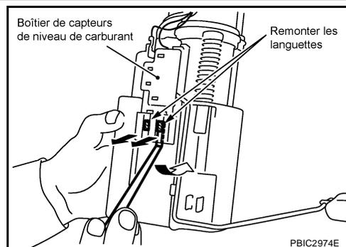
3. Après avoir désengagé les languettes de fixation, faire coulisser le boîtier de capteurs de niveau de carburant pour l'extraire dans le sens indiqué par les flèches sur l'illustration.
