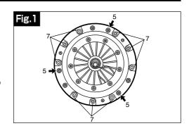
3) M6(3本)、M8(9本)のキャップボルトを使用してクラッチを仮組みし、クラッチのセンター出しをする。
